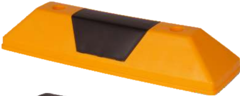
14261 GG Leitschwelle 0,55 m gelb mit schwarzem Einleger L x B x H 550 x 155 x 100 mm, PP 1,85 kg ohne Befestigungsmaterial 22,50 €/Stk
